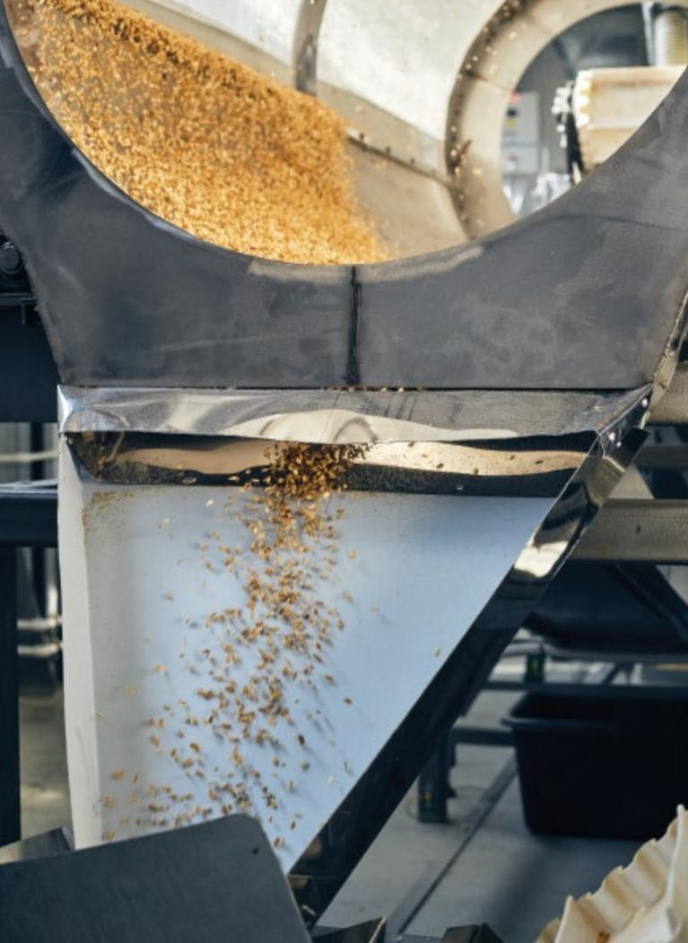
Tamiz rotativo encargado de eliminar de forma fiable partículas no deseadas y limpiar el grano para su posterior almacenamiento. A la derecha, proceso de clasificación automática de granos para su producción industrial. En la anterior página, banda de secado y descascarillado de granos de trigo.
