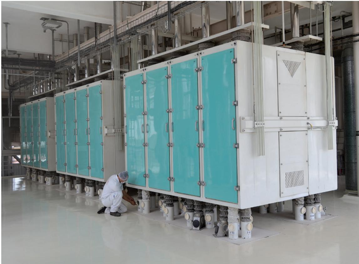
Sesores que purifican y clasifican la sémola de trigo y moliendas compactas. Abajo, molinos de cilindros para
