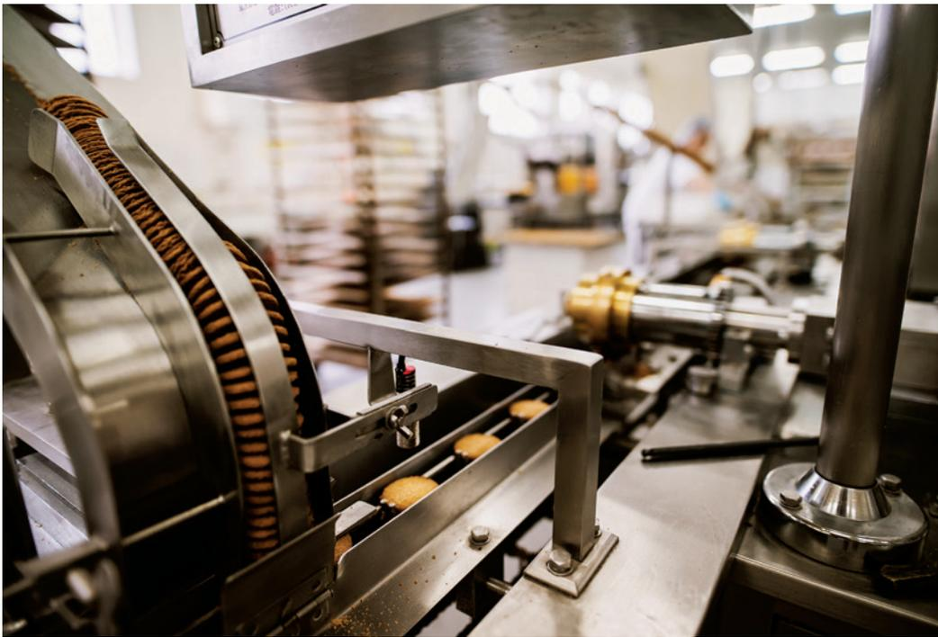
Proceso de dosificación de la crema de manera automática. Abajo, enfriamiento de las galletas luego del horneado.
